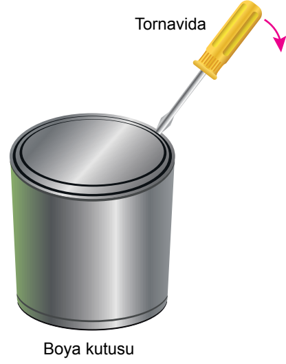
Şekil 2: Boya kutusunun kapağı tornavida ile açılıyor.
